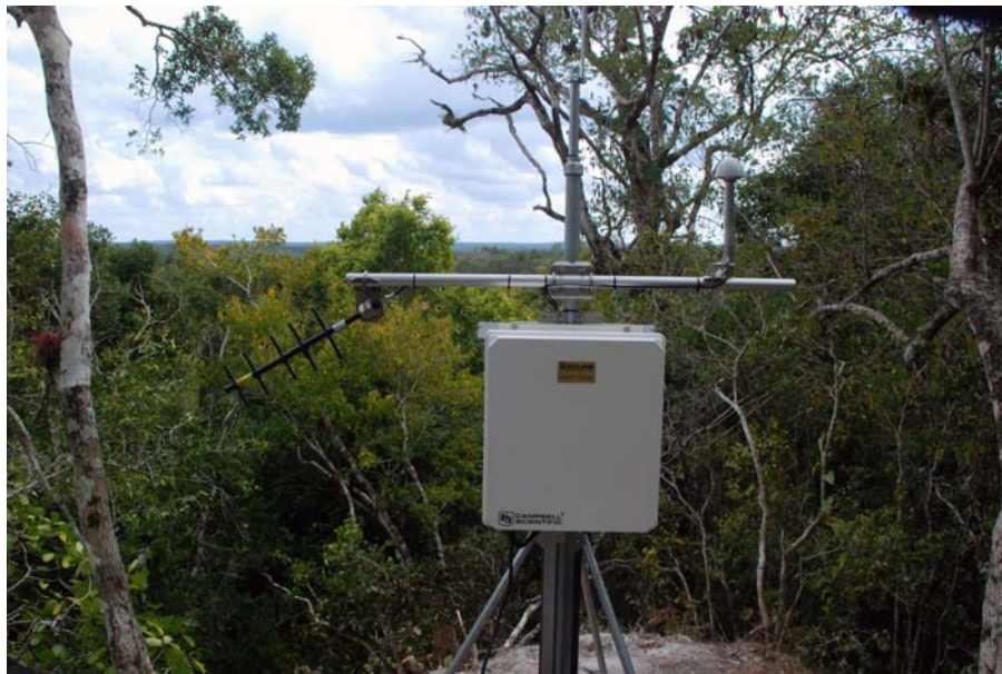
Fig.3.1.6. Caja de recepción en la antena 1. Foto L. Romero
