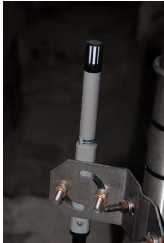
Fig.3.1.17. Sensor de humedad interior. Foto. L. Romero
