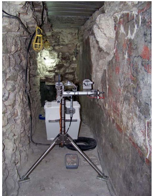
Fig.3.2.13. Colocación de sensor de temperatura/humedad relativa para seguimiento y control en sub-1a. Foto A. Coronado.
