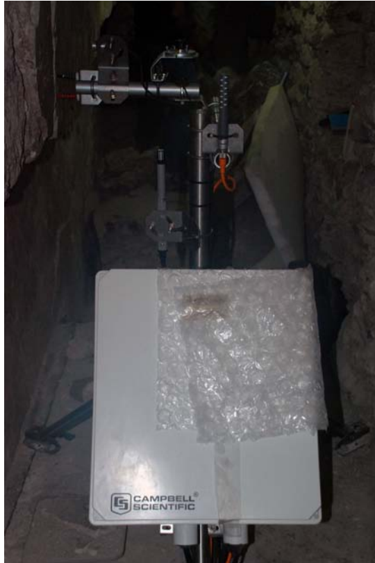
Fig.3.1.5. Caja y receptor de movimiento dentro del túnel de Las Pinturas. Foto L. Romero.
