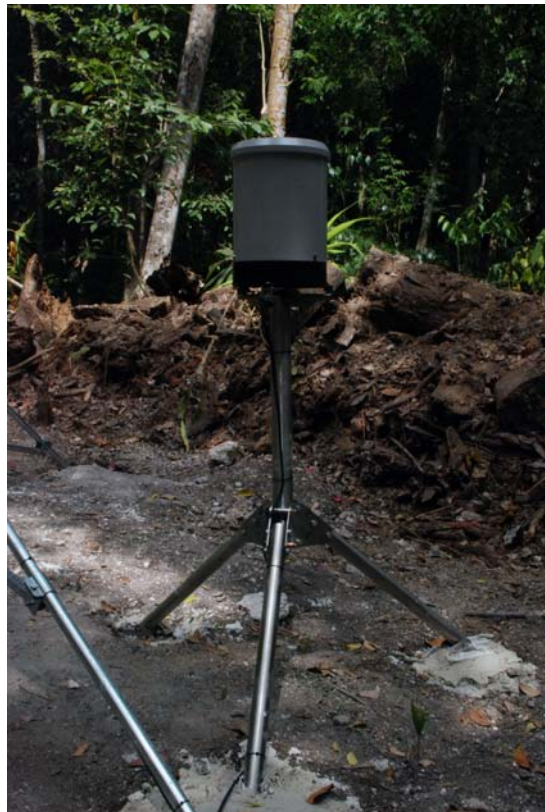
Fig.3.1.15. Pluviómetro, colocado junto a la antena 2. Foto L. Romero
