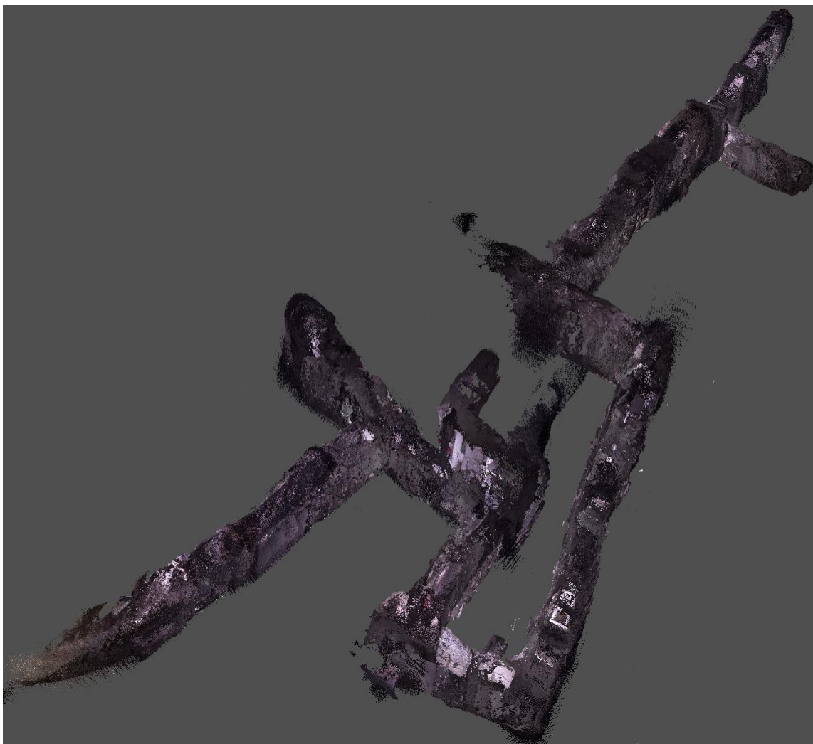
Figura 7.6. Reconstrucción de la excavación principal M7-1, utilizando Kinect v1 y RTAB-Map, realizado en 19 minutos
