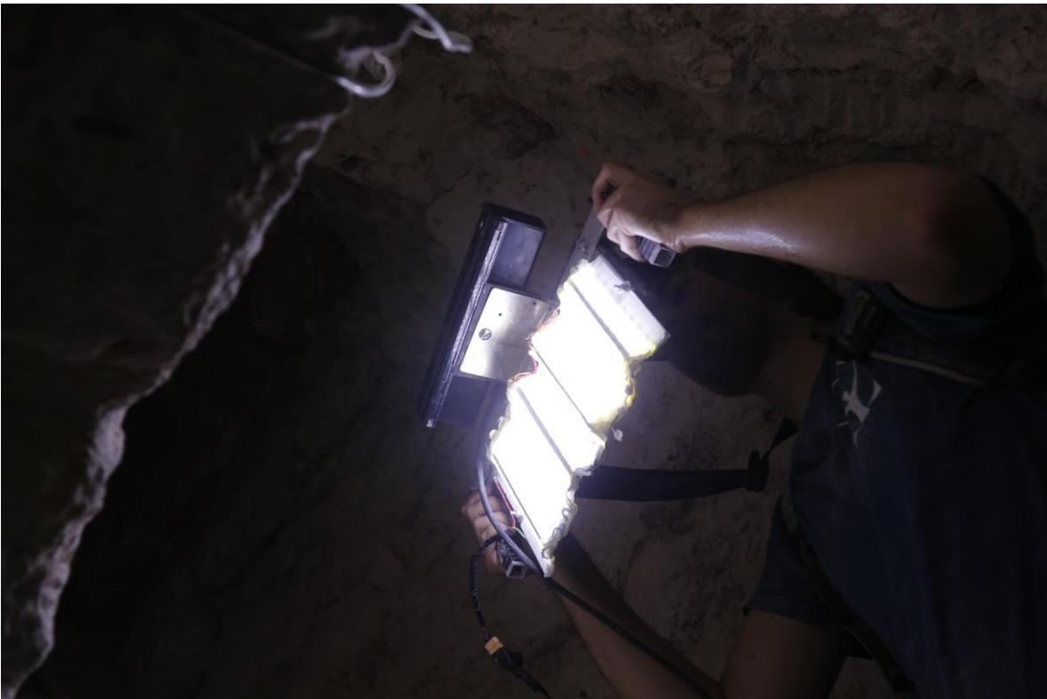
Figura 7.10. Fotografía que muestra el escaneo tridimensional empleando el Sistema Portátil desarrollado.
