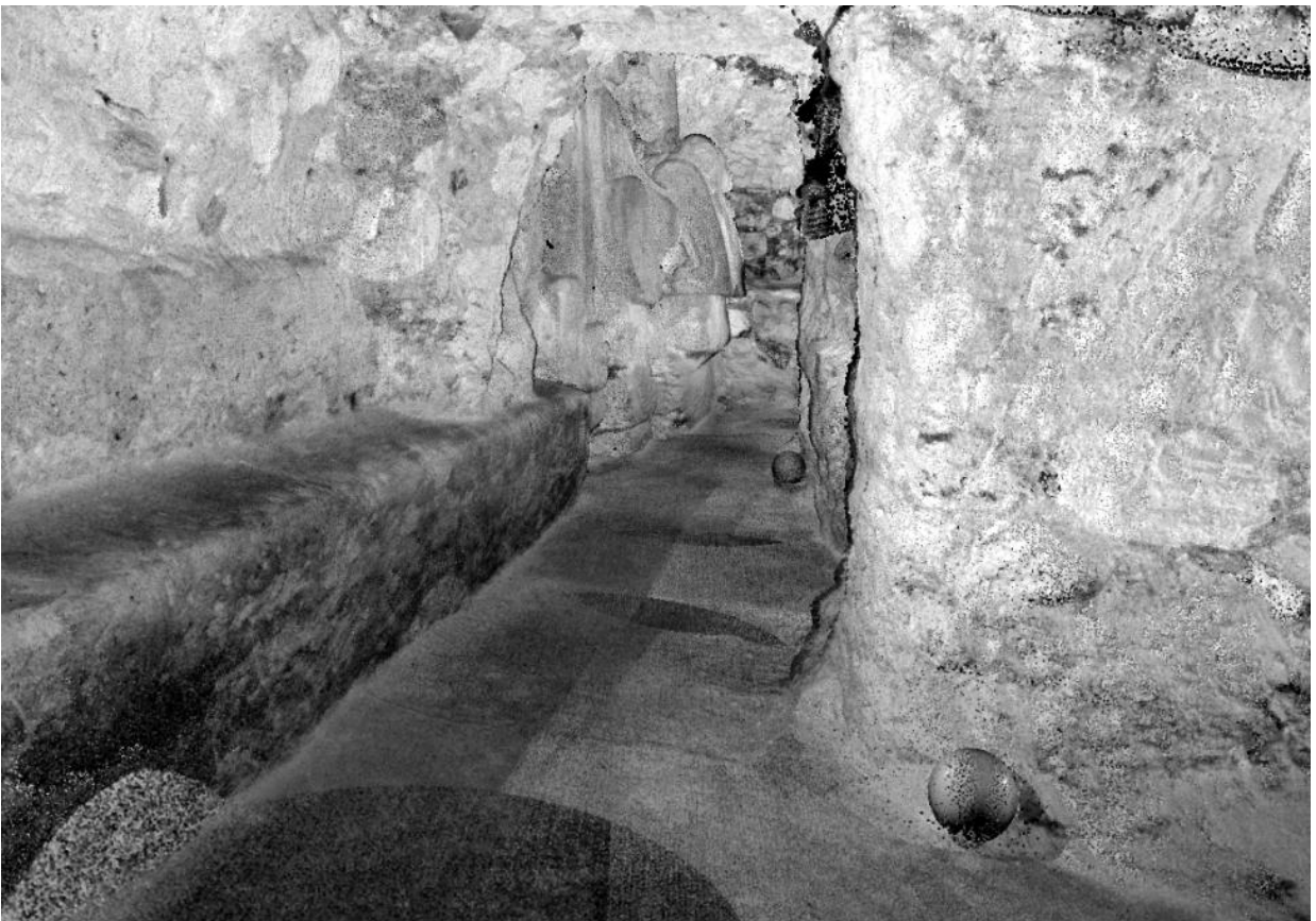
Figura 5. Captura de pantalla mostrando las pelotas de control (en el piso del túnel) que se usa para unir los escaneos del FARO Lidar (imagen por E. Lo, 2019).
