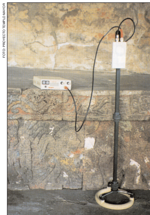
6. Equipo para la medición de la susceptibilidad magnética. En la Casa de las Águilas, a pesar de que los contextos urbanos son problemáticos para la aplicación de técnicas magnéticas, ese tipo de equipos permitió detectar la presencia de piedra volcánica bajo el piso.
