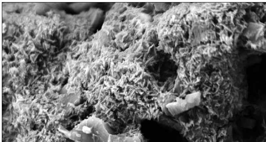
Imagen de microscopía electrónica donde se observa cómo la película de KSE 300 cubre la capa pictórica fijándola al sustrato rocoso.
