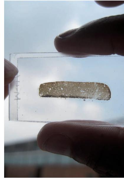
Figura 2. Lámina delgada de una muestra de cerámica. Fotografía de Alejandro Torres Montúfar.
