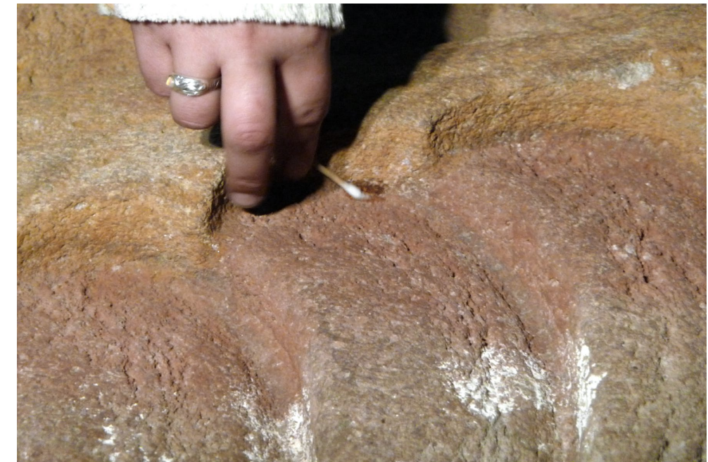
FIGURA 146. Pruebas con hisopo rodado para evaluar el fijado (MBR).
