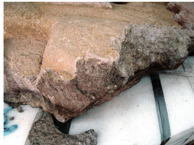
FIGURA 73. Consolidación local sobre canto del fragmento A (CML).
