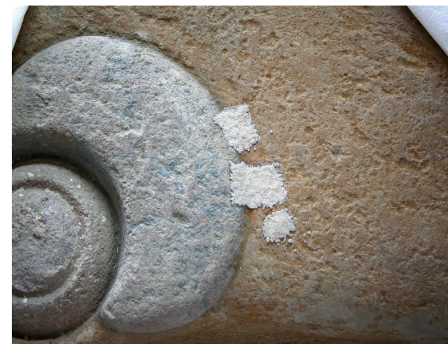
FIGURA 91. Pulpa de papel sobre las tres pruebas aplicadas (MBR).
