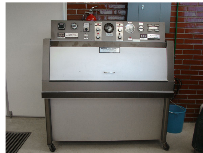
FIGURA 95. Cámara de envejecimiento acelerado (CBM).
