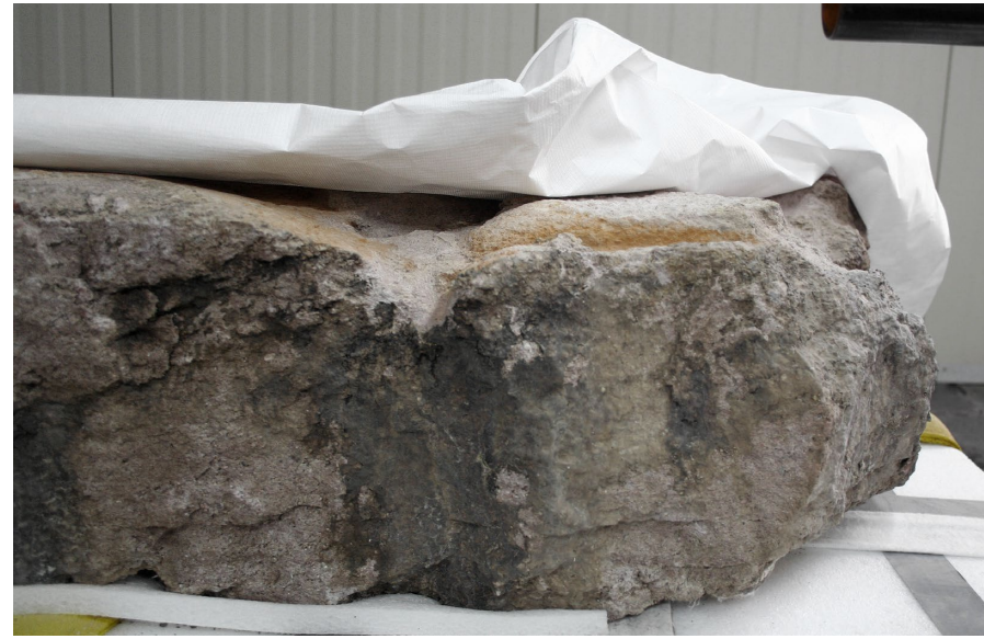
FIGURA 68. Velos y concreciones salinas sobre algunos de los cantos (CBM).
