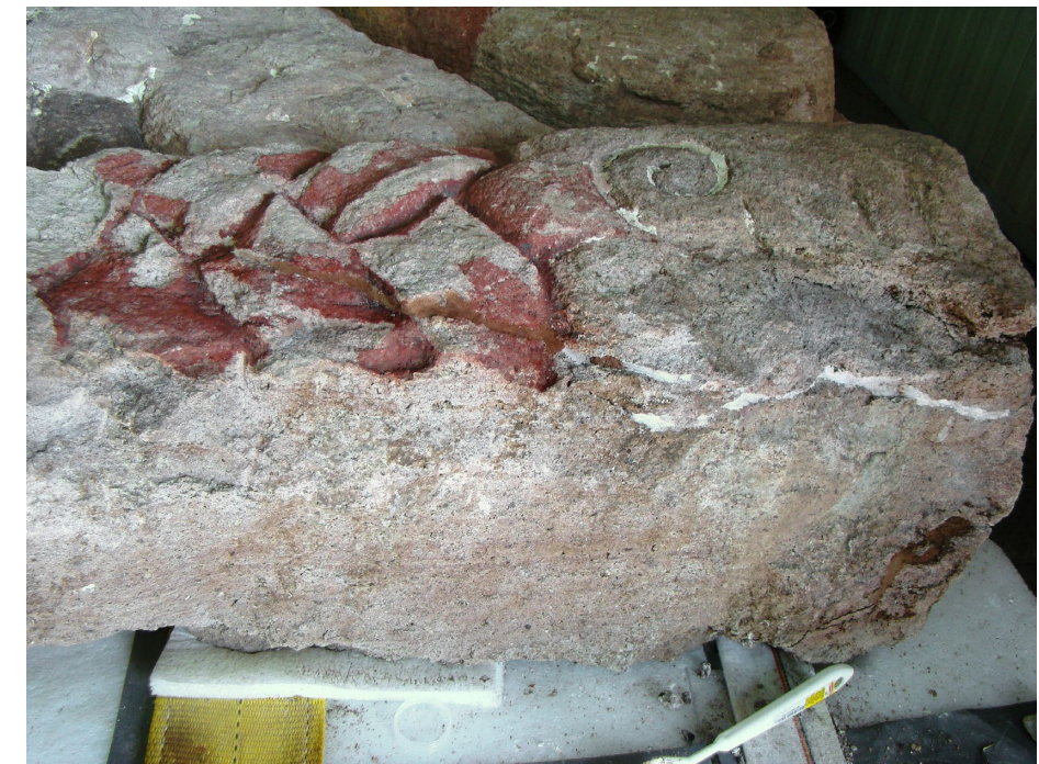
FIGURA 81. Resane en proceso de reintegración cromática (CBM).
