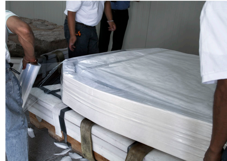
FIGURA 160. Sujeción del embalaje con película autoadherible (JMG).
