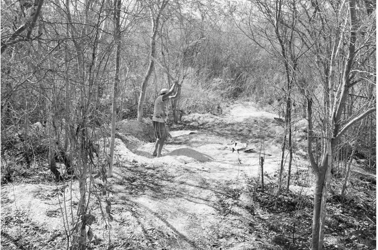
Figura 10. Minadores pasando los fragmentos de palygorskita a través de una malla de alambre.
