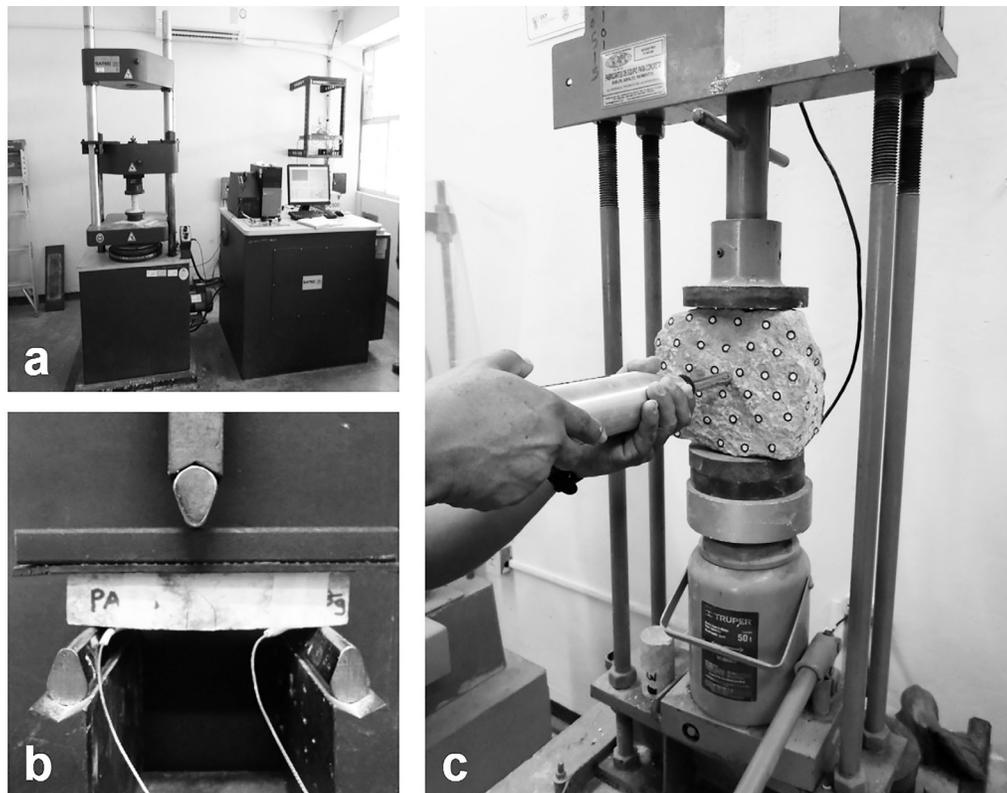
Figura 10. Pruebas mecánicas: a) Ensayo mecánico a compresión con equipo Satec System Instron FI-UADY, b) Ensayo mecánico a flexión de tres puntos acoplado con Emisión Acústica, CICY; c) Medición de dureza superficial con esclerómetro, FI-UADY.
