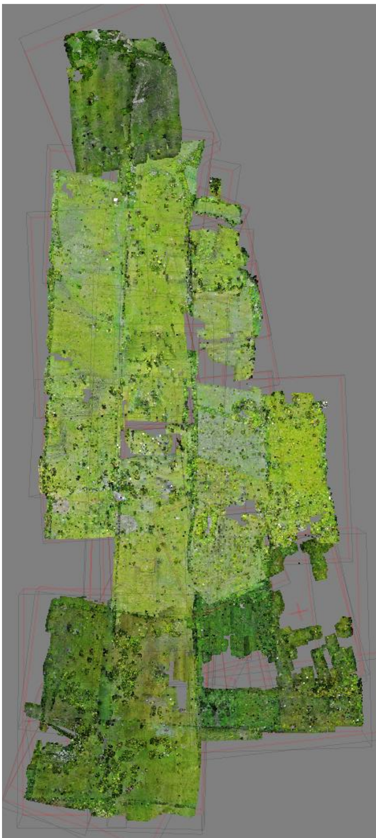
Figura 10.15. Resultado de la modelización con textura, realizada por PhotoScan, realizado por J-B LeMoine.
