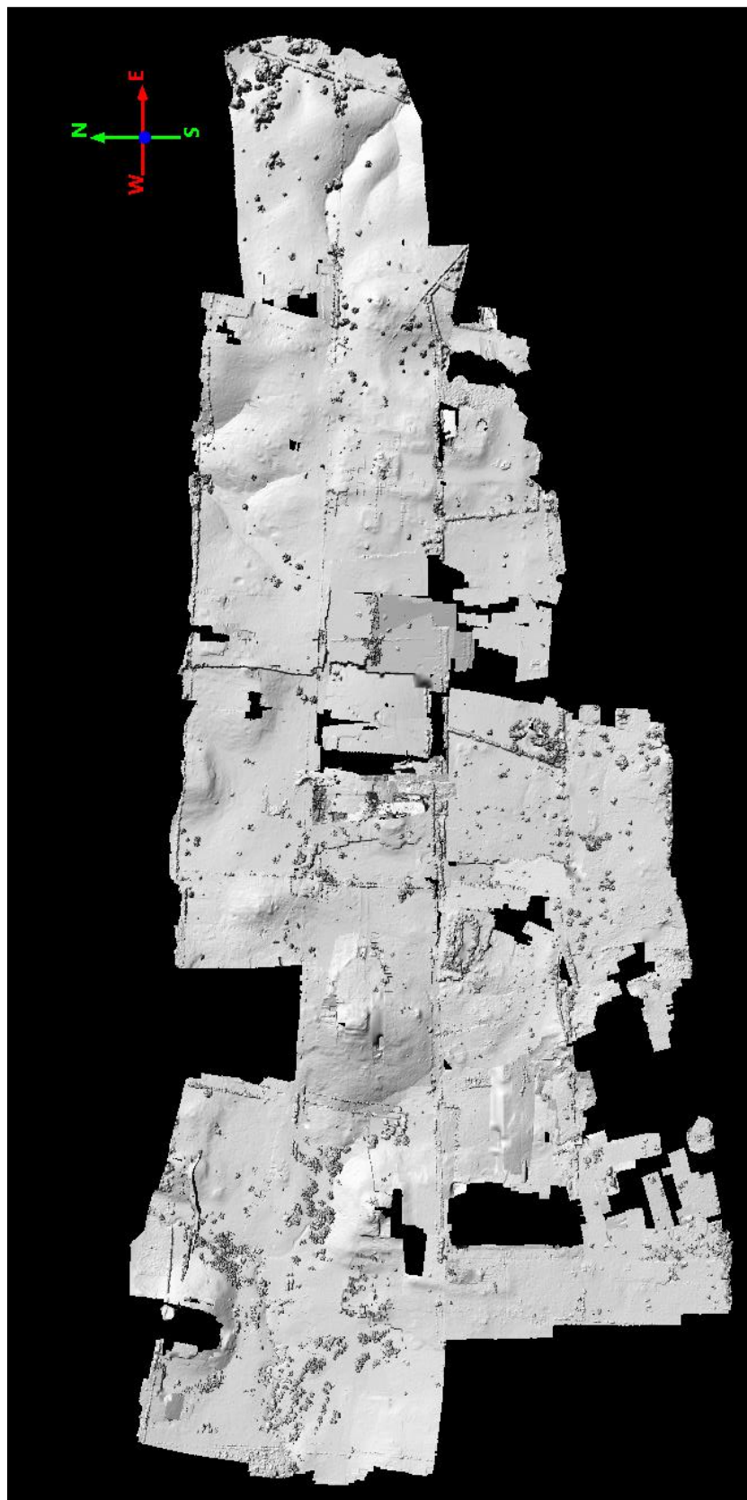
Figura 10.17. Modelo digital de elevación con las correcciones de Quick Terrain Modeler, realizado por J-B LeMoine.
