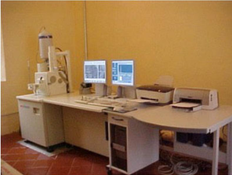
**Foto 10.3. El Microscopio Electrónico de Barrido empleado.**
